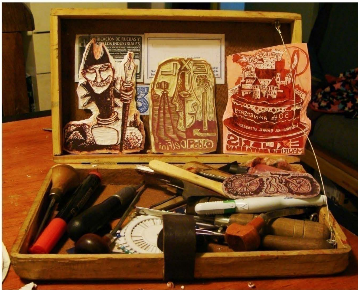
Matrices plásticas y herramientas para desbastar: gubias y buriles.
